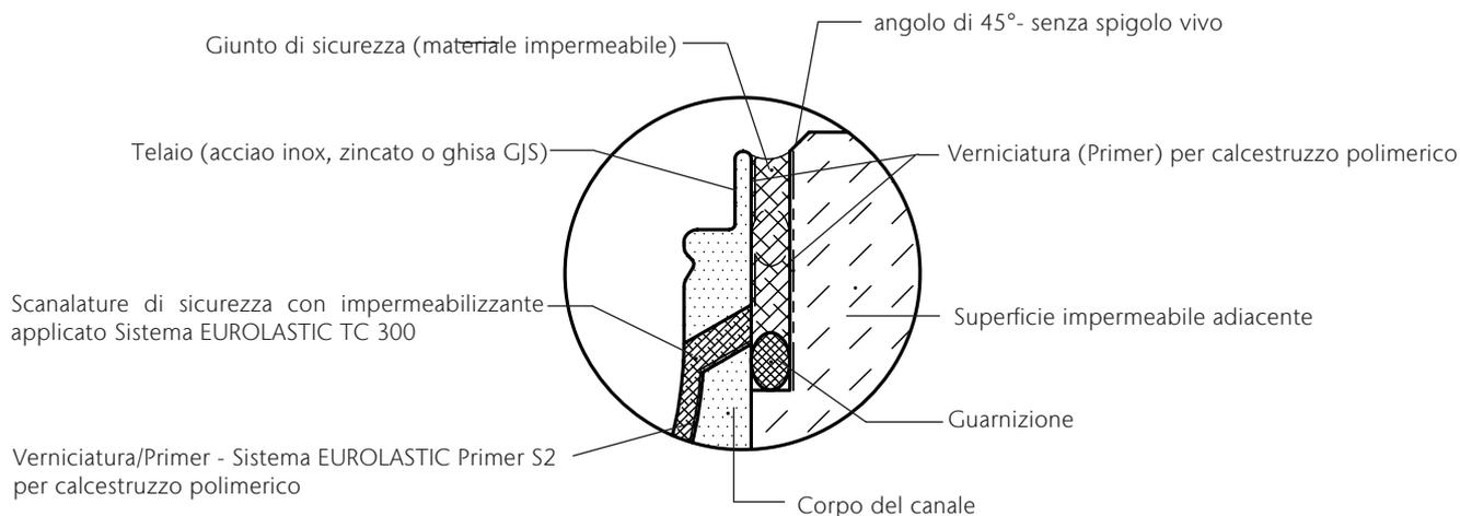
L'impermeabilizzante deve essere applicato con cura in tutte le scanalature di sicurezza fino all'uscita delle scanalature del canale. Avvalersi delle apposite istruzioni precedentemente descritte alla voce: Kit per collegamenti di sicurezza EUROLASTIC
