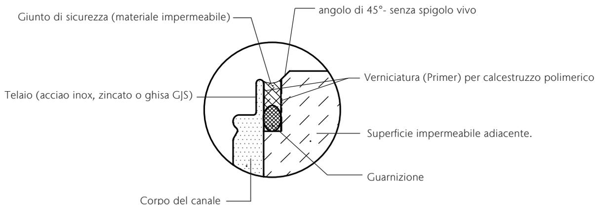
La predisposizione dei giunti di sicurezza tra il telaio e la superficie adiacente deve essere conforme alle indicazioni tecniche riportate. L'applicazione del primer e la costruzione dei giunti deve essere conforme alle indicazioni del produttore dei materiali impermeabili utilizzati per i giunti.
